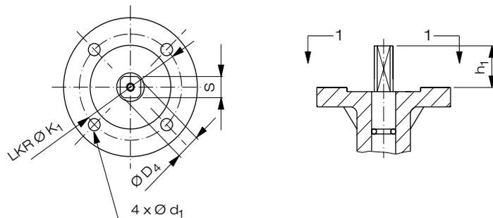
Kopfflanschmaße in [mm] für Befestigung und Antriebsaufbau (DIN EN ISO 5211)
