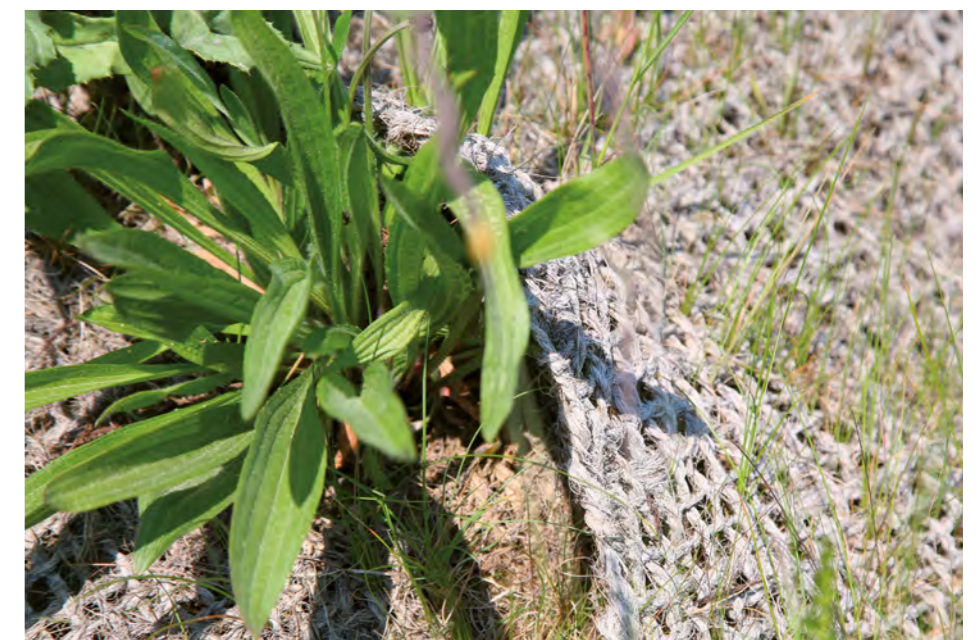
Jutegewebe im Bewitterungsversuch
