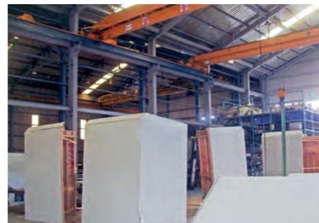
Im Betonwerk vorgefertigte ausgekleidete Betonbauwerke verkürzen die Montagearbeiten vor Ort
